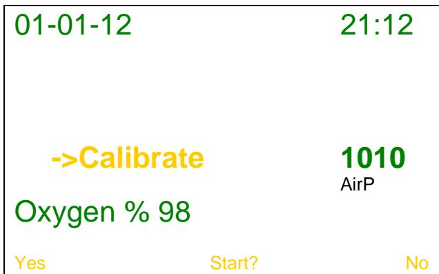
Если показания датчиков будут стабильны в течение 10секунд и будут находиться в рабочем диапазоне, калибровка будет произведена автоматически. В противном случае, датчик (датчики) будет переключен в состояние **OFF**(неактивный).
