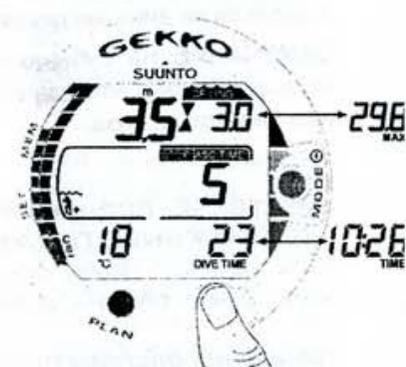
Рис. 3.17 Декомпрессионное погружение, глубина зоны потолка. Две стрелки, направленные друг на друга, указывают, что Вы в зоне «потолка» (глубина 3.5 м.). Минимальное время всплытия 5 минут. При нажатии на кнопку **TIME** на дисплее отобразится текущее время.
