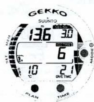
Рис. 3.16 Декомпрессионное погружение, глубина меньше глубины «пола».
