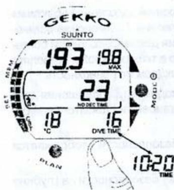
Рис. 3.7 Режим погружения. Текущая глубина 19.3 м, оставшееся время бездекомпрессионного погружения для Высотной/Индивидуальной настройки A0/P1 составляет 23 минуты. Максимальная глубина достигнутая в течение данного погружения 19.8 м Температура воды 18 градусов. Время погружения 16 мин. Альтернативно (в течение 5 секунд), при нажатии на кнопку TIME, будет отображаться текущее время - 10:20.
