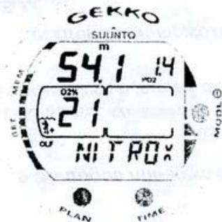
Рис. 3.20 Режим NITROX. Максимальная глубина погружения при текущих параметрах смеси (21% O<sub>2</sub> и 1.4 бар. PO<sub>2</sub>) - 54.1 м.
