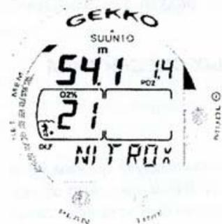
Рис. 3.22 Погружение в режиме NITROX. Значение O<sub>2</sub>% - 21%.
