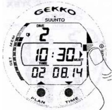
Рис. 4.10 Дневник погружений, вариант 1. Для выбора номера погружения нажимайте кнопку SMART.
